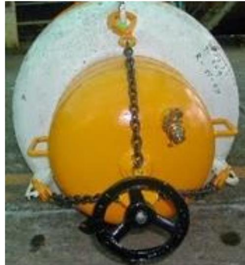
Si la fuga es sobre el propio cuerpo del bidón a presión, esta debe ser tratada con la herramienta de contención y apriete correspondiente. A diferencia de los anteriores, en este caso el bidón a presión, en posición horizontal, debe elevarse un poco para poder pasar la cadena o cinta de sujeción del útil.
