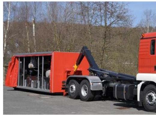
Para fugas de menores dimensiones se puede hacer uso de unidades más pequeñas, pero que trabajan sobre el mismo principio. El primer depósito contiene la solución alcalina y el segundo simplemente agua. En el primero de ellos se produce la absorción del cloro y en el segundo la de otros gases no reactivos generados en la primera reacción.
