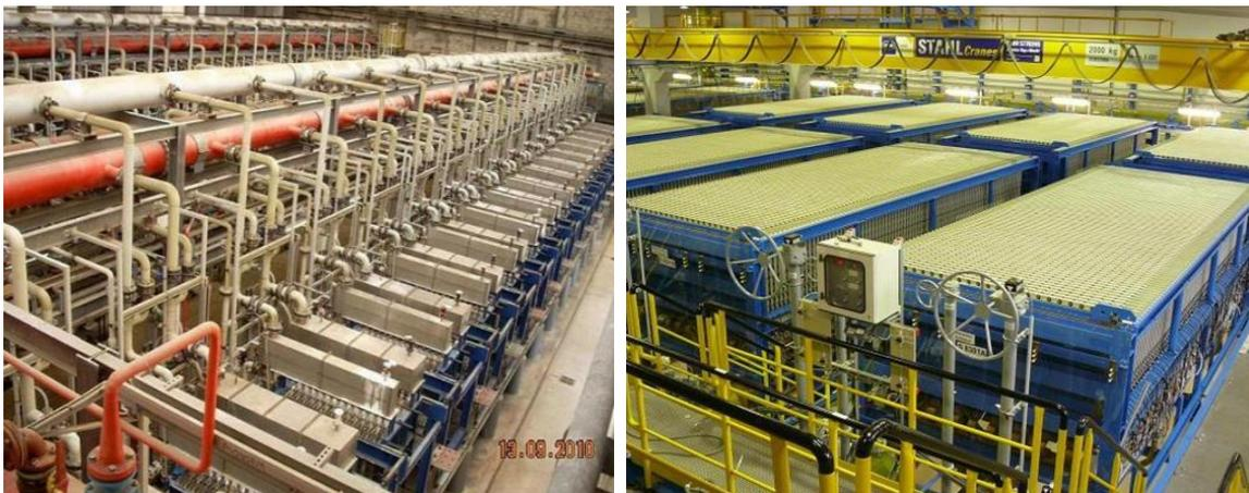
Dispositivo de celdas de membrana – monopolar (izda) – bipolar (dcha)
