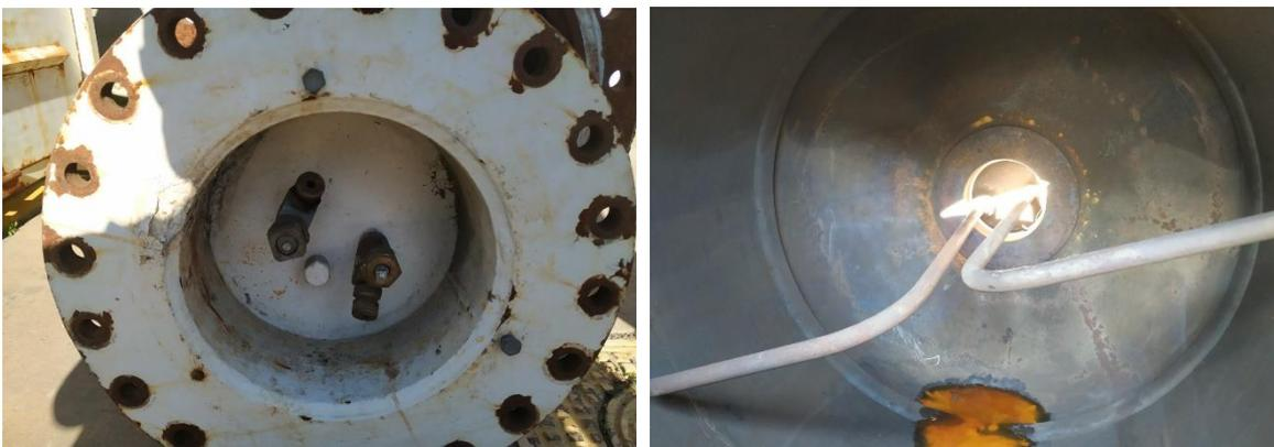
Válvulas y tubos buzo interiores del bidón a presión de cloro
