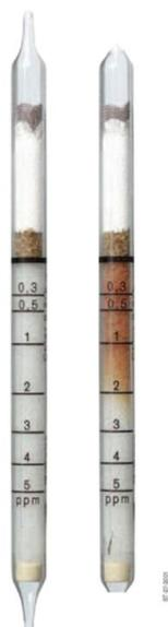
Son equipos de lectura directa aplicables a la determinación de gases y vapores. Son, junto a otros sistemas de medición colorimétrica, equipos que se basan en el cambio de color que sufre un reactivo específico al reaccionar con un contaminante determinado.
