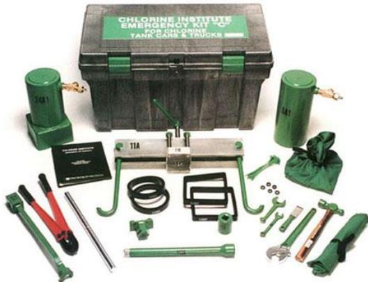
Este equipo está diseñado para trabajar sobre cisternas, ISO-contenedores o vagones cisternas de los modelos DOT para cloro; raramente son utilizados en Europa en cisternas P22DH (M) debido a que el sistema de válvulas, sus conexiones y la disposición son algo diferentes.
