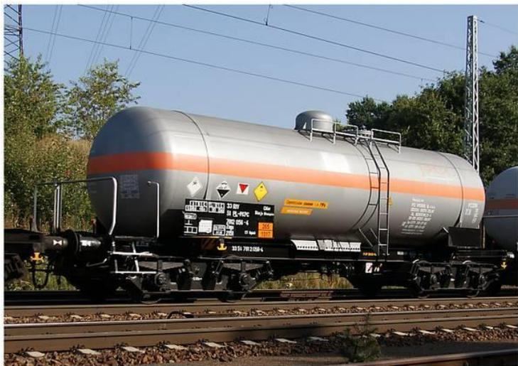
El ADR establece que las placas-etiquetas 2.3+5.1+8 deberán fijarse en los dos laterales y la trasera del vehículo; también llevarán dos paneles rectangulares de color naranja, uno en la parte delantera de la unidad de transporte y el otro en la parte trasera, con el código de identificación de peligro y el número ONU correspondiente.
