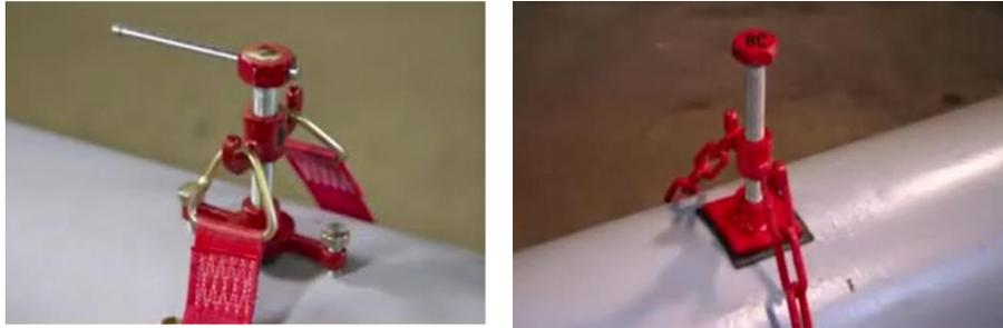
útil para taponamiento de fuga sobre el cuerpo del cilindro
