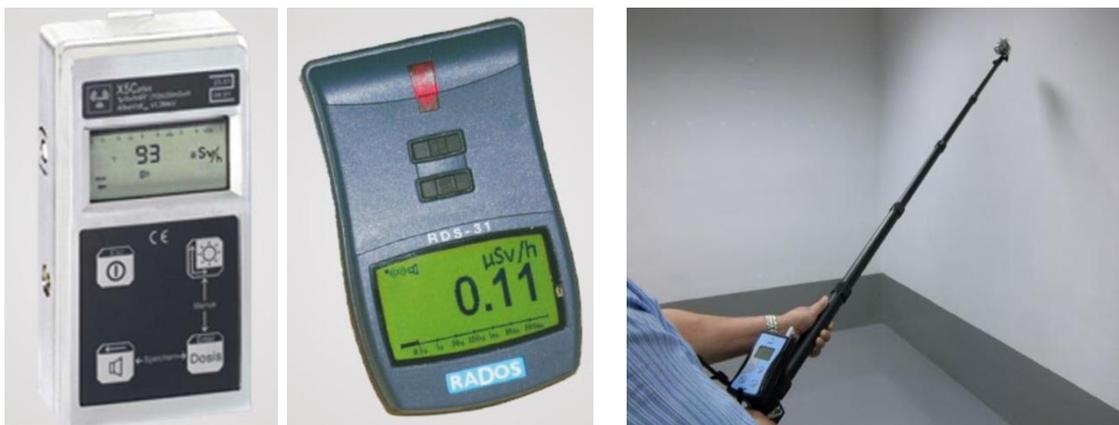
CONTAMINÓMETROS o medidores de contaminación.
