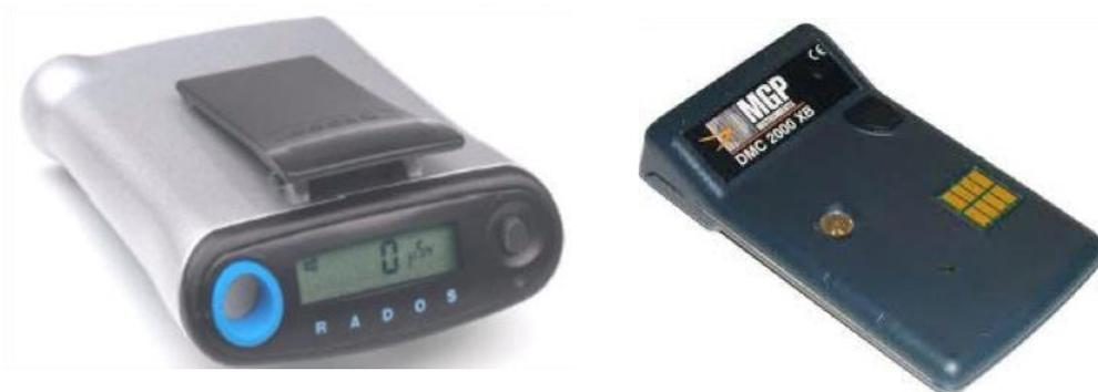
El dosímetro es un equipo fundamental en todas las fases de la Intervención, pero en este caso se utiliza como un equipo de *rápida detección en primera respuesta* utilizándolo como un medio ligero, fácil de manejar y fiable que puede darne una idea clara de si estoy en presencia de radiación y si los niveles son altos, simplemente
