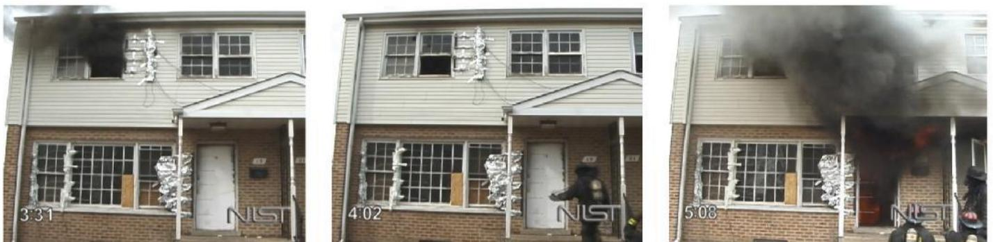
Figura 8 - Investigação realizada pelo UL sobre o desenvolvimento de um incêndio num edifício (Fonte: NIST).
