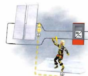
Fig. 20 - Contact direct et décharge capacitive
