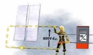
Fig. 18 - Contact direct avec deux conducteurs actifs
