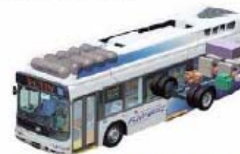
Figure 1 : Bus hydrogène - 25 à 40kg d'H 2
