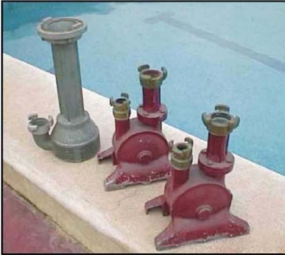
El Hidroejetor, es una máquina hidráulica, con la cual podemos aspirar agua o otro líquido, utilizando el agua que impulsamos con ayuda de una bomba.
