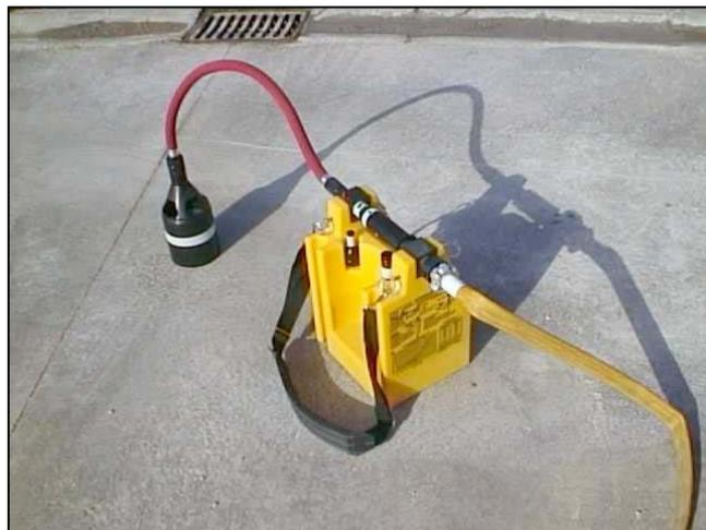
**Premezclador y depósito en punta de lanza**
