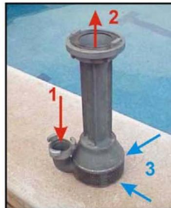
El agua a presión, procedente de la bomba del vehículo entra por (1), transformando su energía de presión en velocidad en el estrechamiento (4), esto hace que disminuya la presión, en virtud del Efecto Venturi, y aspira el líquido que entra por la entrada (3).
