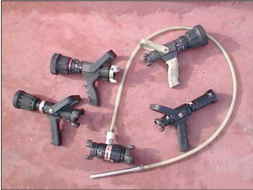
La lanza es un aparato hidráulico que situamos al final de una instalación con objeto de transformar la energía de presión, que nos esta proporcionado la bomba, en velocidad con el fin de "lanzar" el agua tan lejos como sea posible con el fin de atacar el fuego<sup>7</sup>.
